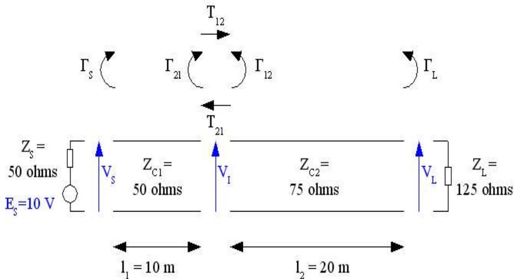
Le générateur, d'impédance interne  $Z_s = 50$  ohms délivre un échelon d'amplitude  $E_s = 10$  V. La charge  $Z_L$  est égale à 125 ohms.
